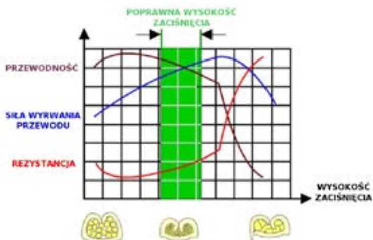
Rys. 5 Zależność przewodności, rezystancji i siły zrywania od wysokości zaciśnięcia
